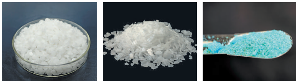
Мал. 30.1. Основи: а — натрій гідроксид являє собою білі гранули; б — калій гідроксид — білі лусочки; в — купрум(II) гідроксид — синій порошок
