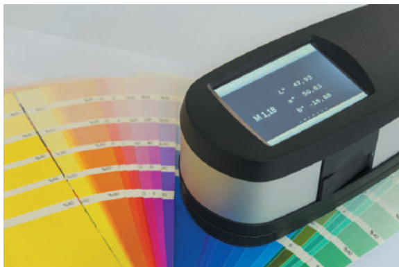
Мал. 41.5. Сучасний спектрофотометр
