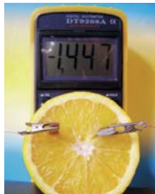
Рис. 7.4. Саморобне хімічне джерело струму
