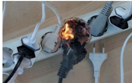
Рис. 8.3. Перевантаження за паралельного з'єднання споживачів електричного струму
