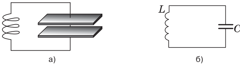
Рис. 16.3. Модель (а) та електрична схема (б) коливального контура
