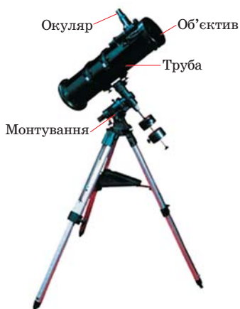
Рис. 35.3. Будова оптичного телескопа для візуальних спостережень: об'єктив, труба, монтування, окуляр
