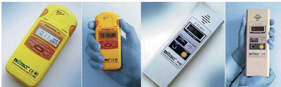
Рис. 26.5. Дозиметри-радіометри РКС-01, «СТОРА», МКС-05 та «ТЕРРА-П»
